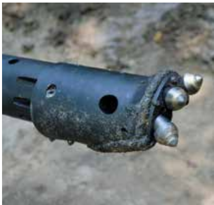
Bohrkopf, Ansicht von vorne, für Bohrungen in festem Untergrund ausgelegt.
